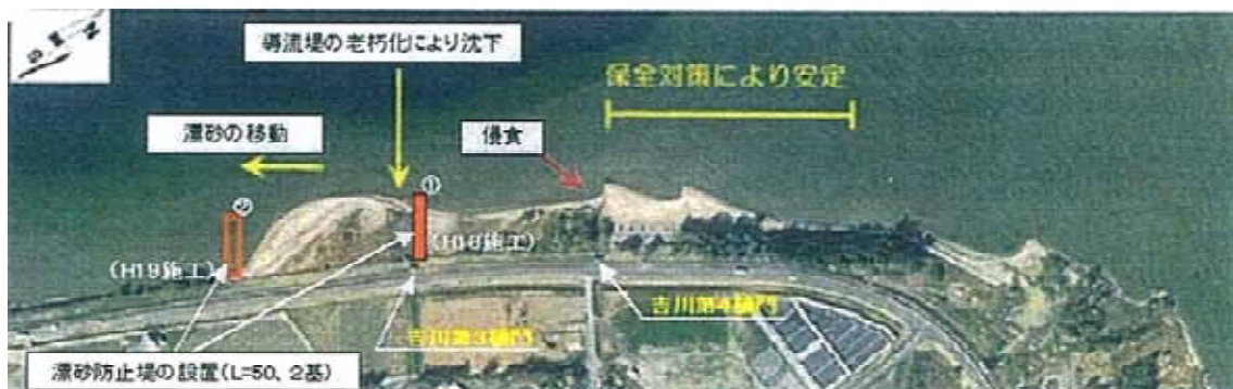
写真－16 湖岸の浸食対策（琵琶湖開発）
