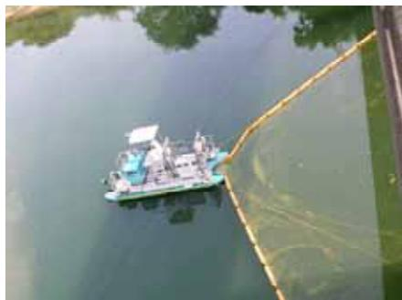
写真 - 4 加圧噴射衝撃浄化装置
