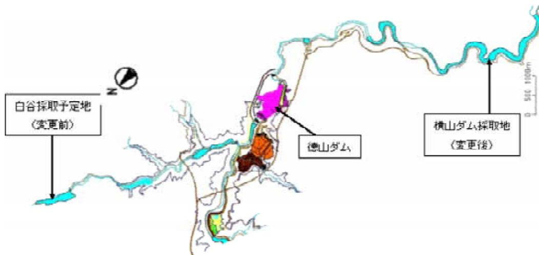
図 - 2 堤体材料採取地の変更（徳山ダム）
