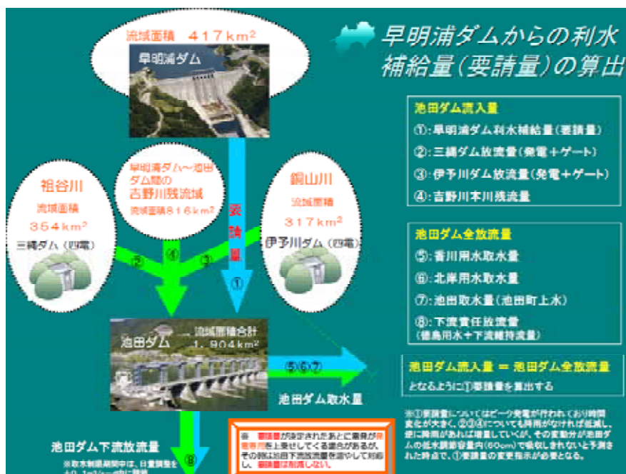
図－3 早明浦ダムからの利水用水補給量算出の方法
