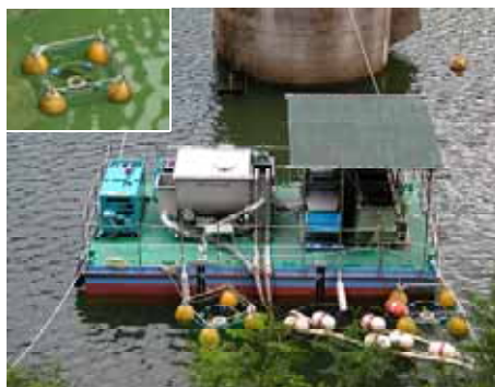
写真-3 藻類処理装置による アオコ回収状況（室生ダム）
