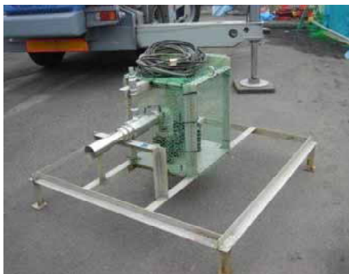
写真－３ 微細気泡発生装置 (正蓮寺川利水)
