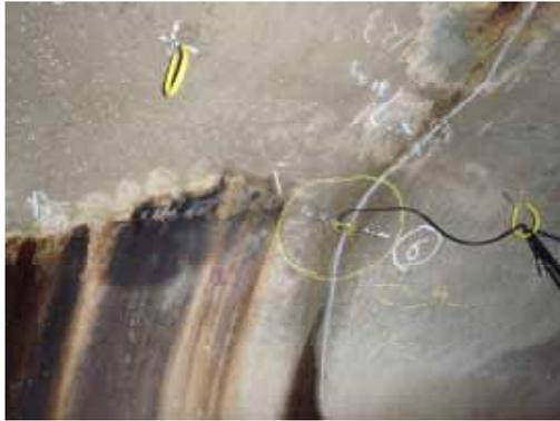
写真 - 2 亀裂計 6 取付状況
