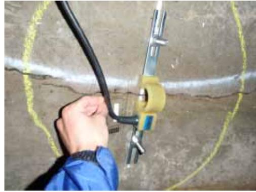
写真 - 3 亀裂計 6 詳細状況
