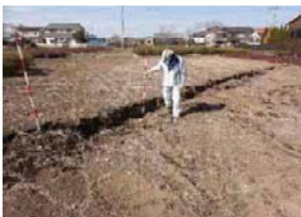
写真 - 5 管路上耕地沈下状況
