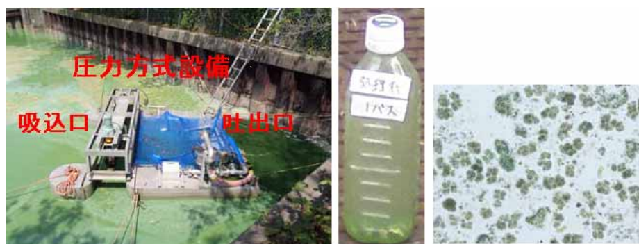
図－1 圧力によるガス胞の破壊
