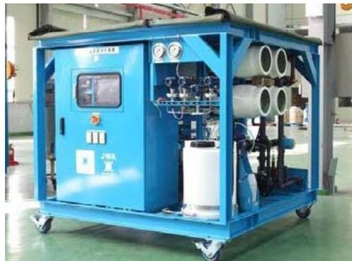
写真－2 新規可搬式海水淡水化装置
