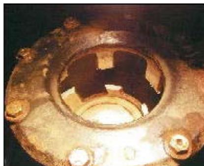
写真－3 空気弁破損（地震の衝撃で破損）
