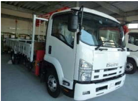
写真-3 ユニーク車 (2.9t吊)
