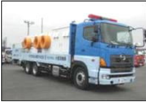
写真-1 ポンプ車 (60m 3 /分)
