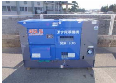
写真-4 発電機 (45kva)
