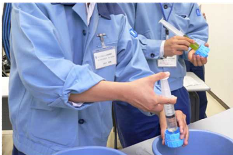
写真-1 ろ紙調査 (アオコを含む湖水をろ紙に吹き付けている様子)
