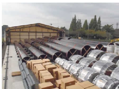
①備蓄資材（鋼管、継手補強材等） （開閉式倉庫）
