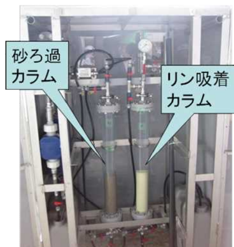
写真-4 連続通水実験装置（長柄ダム）リン回収装置
