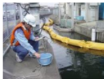
写真-2 簡易水質測定状況 (群馬用水管理所)
