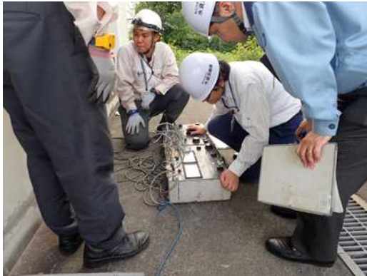
①継電器試験
