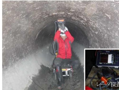
写真-4 電磁波レーダ探査法による調査実施状況
