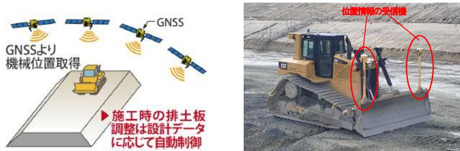
写真-1 GNSSを用いた盛立（層厚）管理
