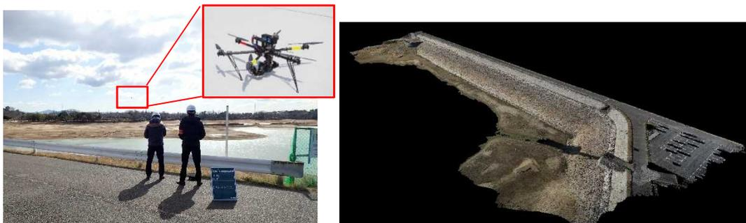
写真-4 UAVを用いた3次元測量
