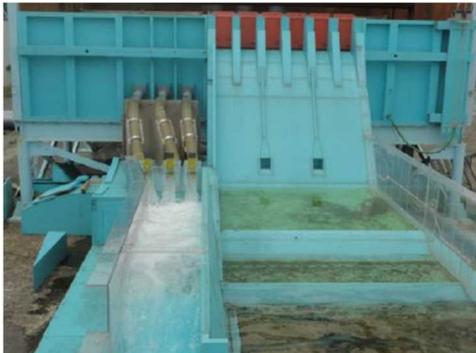
写真-1 水理模型実験（全体模型）
