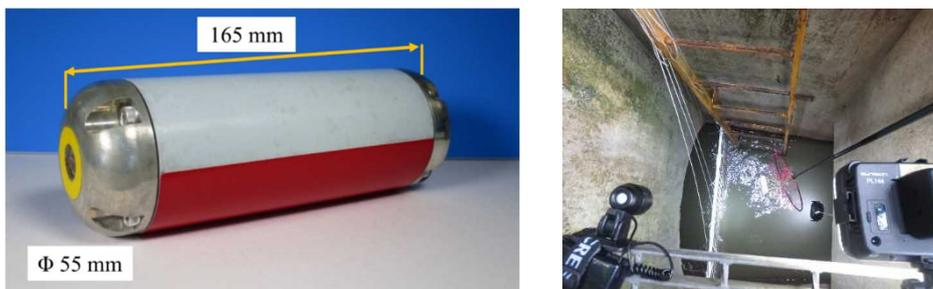
写真-4 木曾川用水 (木曾川右岸施設) (左: 漏水探査ロボット、右: 漏水探査ロボット回収状況)
