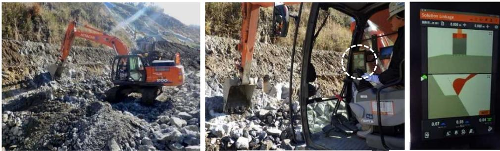
(a) 掘削作業状況 (b) 掘削中の操作状況 (c) モニター表示画面
