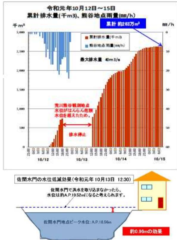
図-15 佐間水門の洪水取込による忍川の水位低減効果
