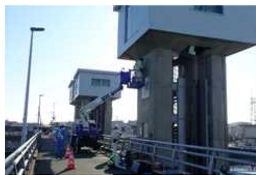
写真-2 弾性波トモグラフィ調査(旧吉野川河口堰)
