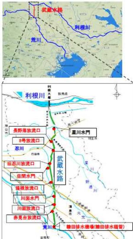
図-14 内水排除等操作した水門・放流口等位置図
