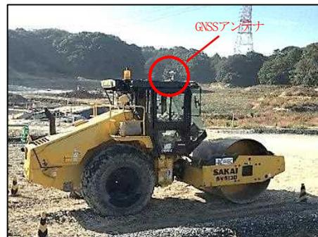
写真-2 GNSSを用いた締め管理
