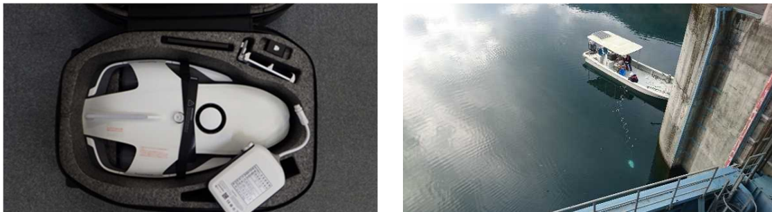
写真-7 水中ドローン本体、使用状況写真
