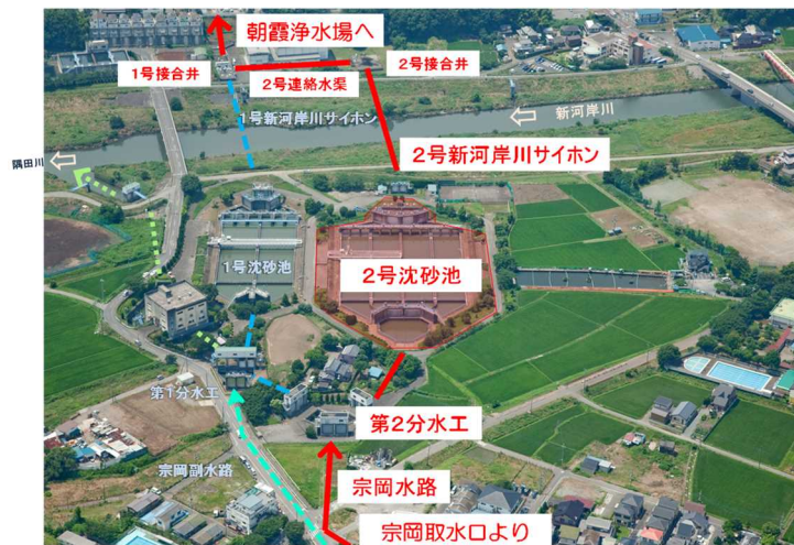
図-2 朝霞水路2号沈砂池等概要
