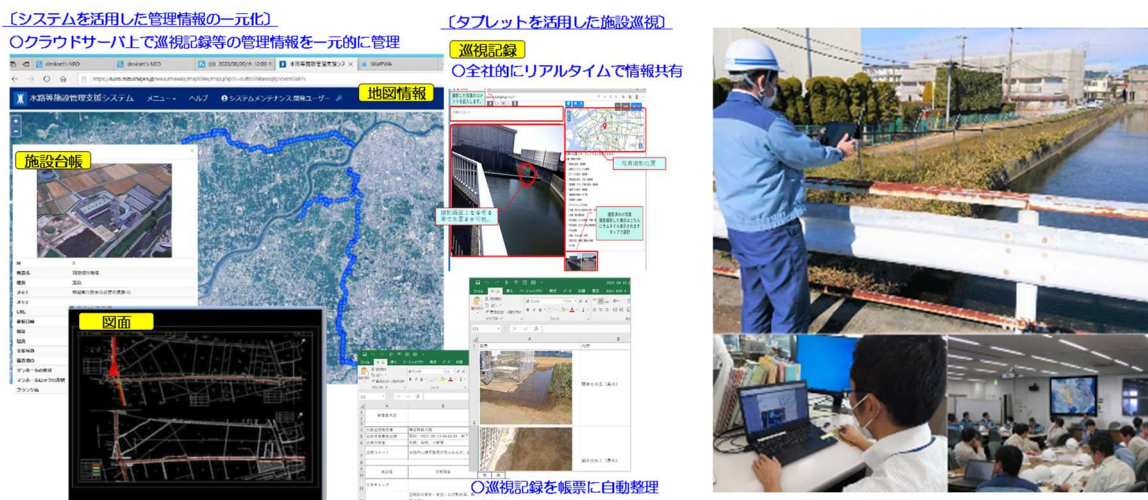
図-6 水路等施設管理支援システム(左図)及びシステムを活用した点検巡視・訓練状況(右図)
