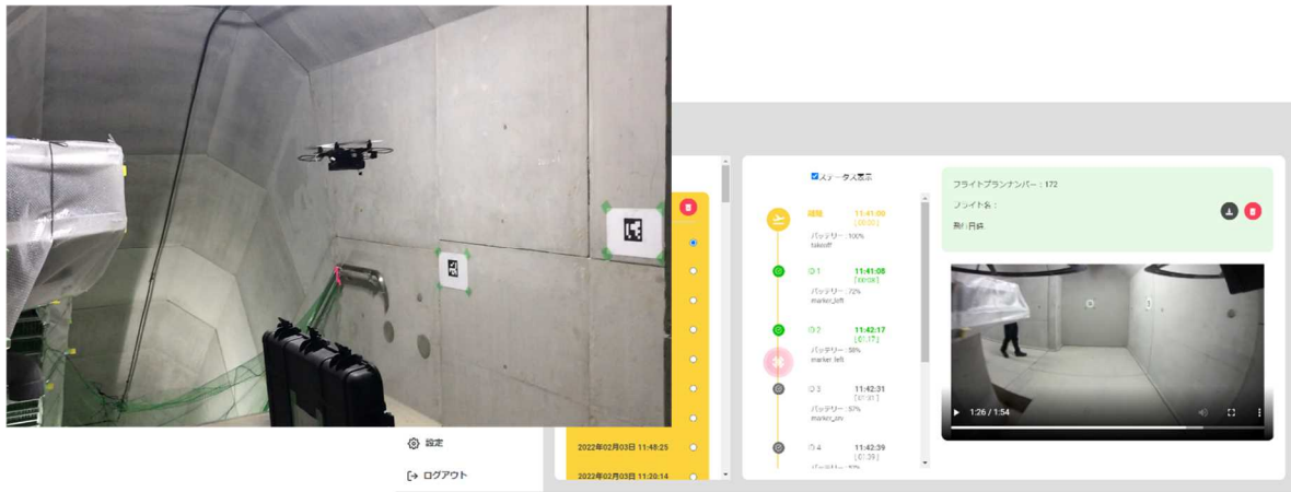
図-5 自律飛行UAVによる監査廊点検の自動化（デモンストレーション）
