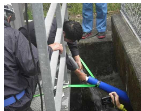
写真-2 漏水探査ロボット流下実証試験（フィールド：木曾川右岸施設）
