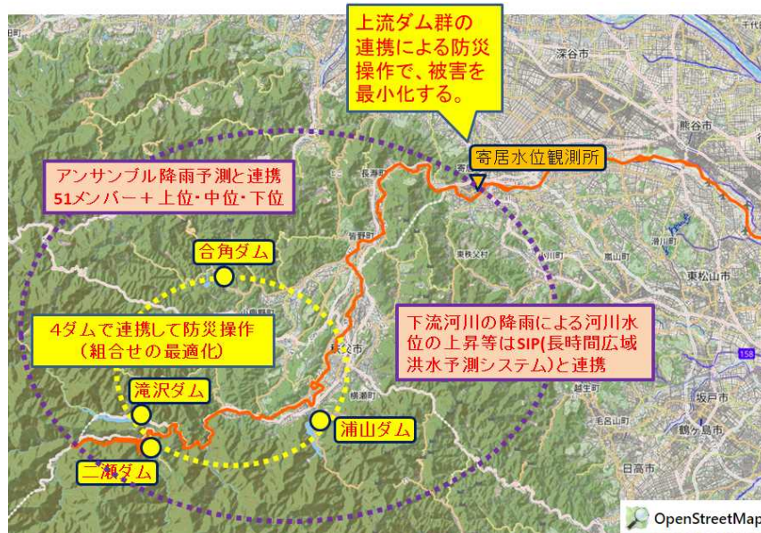
図-3 荒川上流ダム群連携操作支援システム
