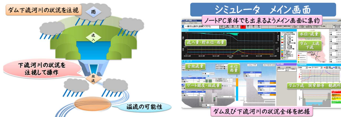
図-1 ダム操作訓練シミュレータ概念図
