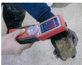
写真-10 帯磁率計による測定
