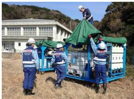
写真-1 可搬式浄水装置設置状況
