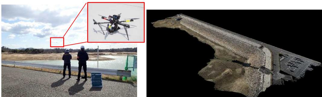
写真-9 三好池堤体耐震補強工事におけるUAVを用いた3次元測量
