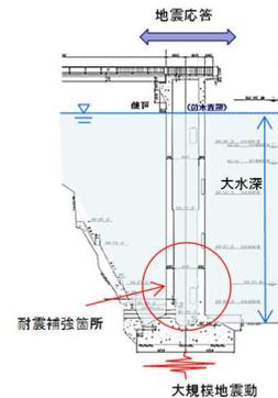
図-3 取水塔の耐震補強工法の検討
