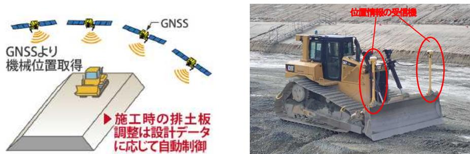
写真-8 佐布里池堤体耐震補強工事におけるICT建設機械の活用
