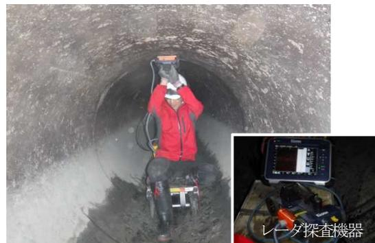
写真-13 電磁波レーダ探査法による調査実施状況
