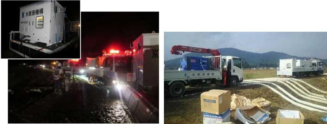
写真-7 ポンプパッケージ10m³/min排水作業 (大町町)
