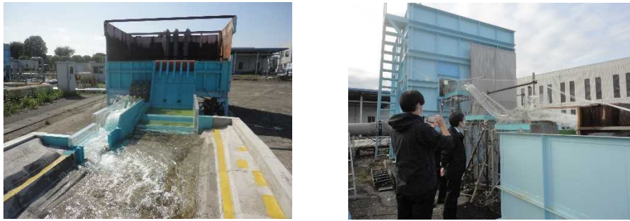
写真-3 水理模型実験の様子（於：水資源機構総合技術センター）
