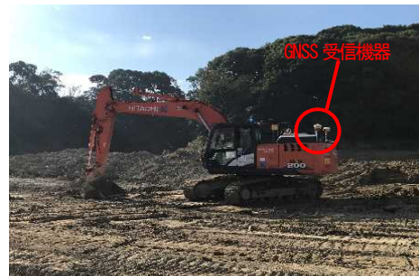
写真-4 GNSSを用いたガイダンス機能の活用
