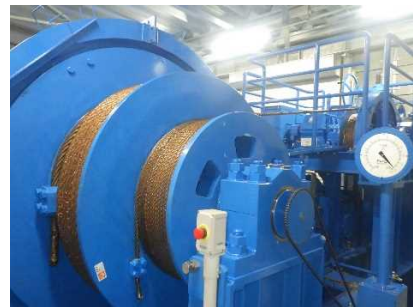
写真-11 利根大堰開閉装置更新実施状況(左:開閉装置据付状況、右:更新後の開閉装置)
