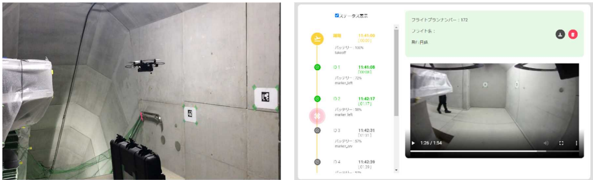
写真-4 自律飛行UAVによる監査廊点検の自動化（デモンストレーション）
