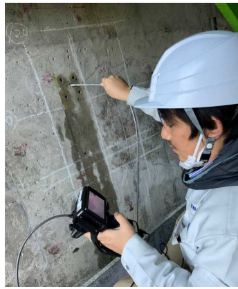
写真-1 内視鏡による孔内調査
