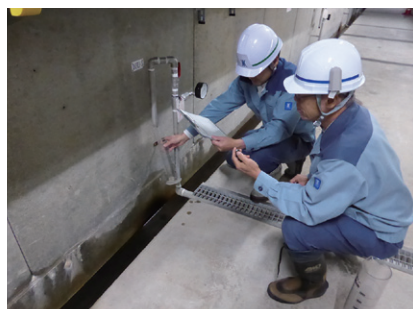
堤体内の漏水量測定(大山ダム)
