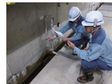
堤体内の漏水量測定(大山ダム)
