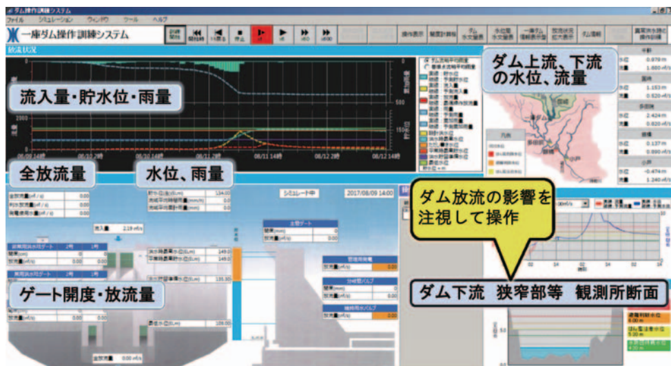
ダム防災操作訓練シミュレータメイン画面
