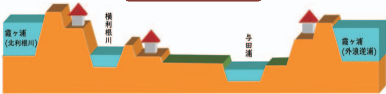
※利根川と霞ヶ浦に囲まれて自然排水できないため、排水ポンプが重要であることが分かります。
