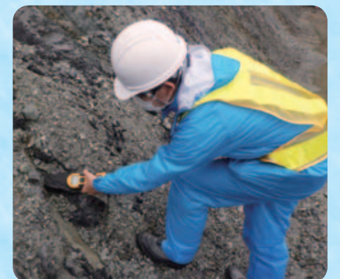
計測機器(帯磁率計)を使用して、ロック材料(玄武岩)の分布を判定しています。
