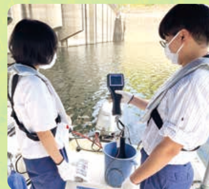
貯水池での水質調査実習の様子。 （バンドーン採水器という機器を使って行います。）
