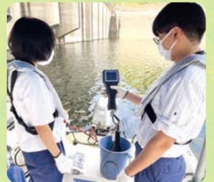
貯水池での水質調査実習の様子。（バンドーン採水器という機器を使って行います。）
