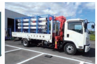
浄水に必要な装置をトラックに積載搬送して、現地で各ユニットを設置し装置を稼働
