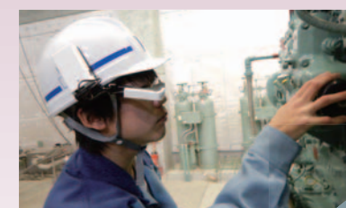
HMD*(ヘッドマウントディスプレイ)を使った操作支援
