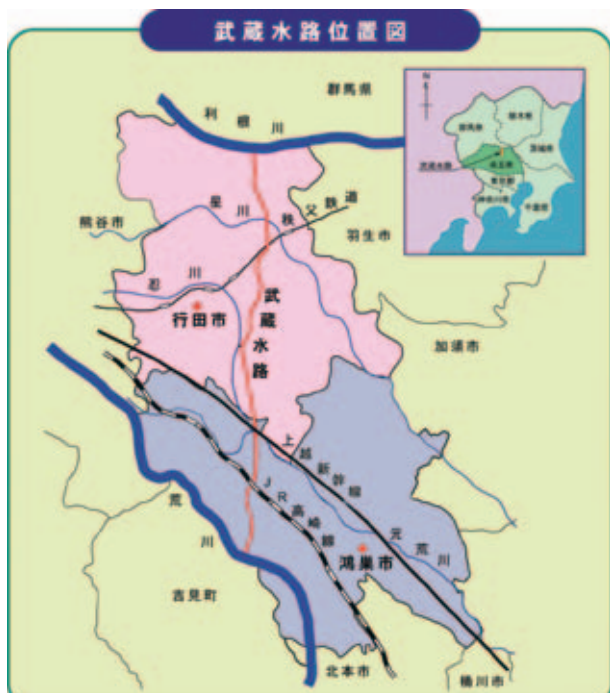
武蔵水路は埼玉県北部に位置する、利根川と荒川を結ぶ約14.5kmの水路。東京オリンピックを控え、深刻な水不足に対応するために造られた水路で、東京、埼玉南部への安定的な水供給に貢献してきた。しかし、昭和42年の工事完了後から約45年が経過し、施設の老朽化による通水能力の低下が見られるようになったため、平成22年度から水路全線の改築工事を開始し、平成27年度の工事完了予定で現在工事を進めている。
