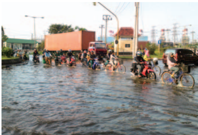
地下水の過剰利用により地盤沈下が進行し、満潮時には毎日冠水するインドネシア Semarang 市の工業地区
