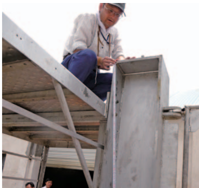
通船ゲートの工場検査
