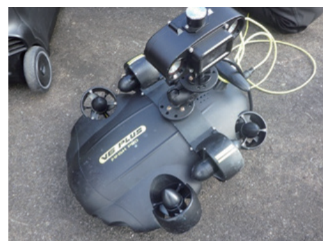
(左:水中ドローン本体、右:水中ドローン操作状況) ICT等新技術を活用した機能診断調査(福岡導水)
