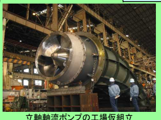
立軸軸流ポンプの工場仮組立
