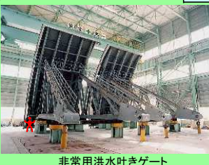
非常用洪水吐きゲート
