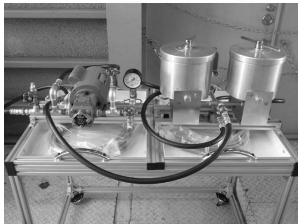
写真-8 可搬式油ろ過装置
