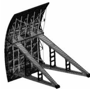
図-7 ラジアルゲートの3次元シェルモデルによる動的解析
