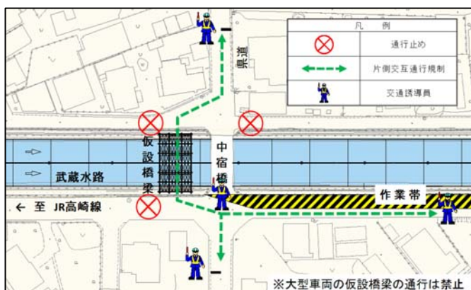
図-1 中宿橋改築工事中の規制状況模式図
