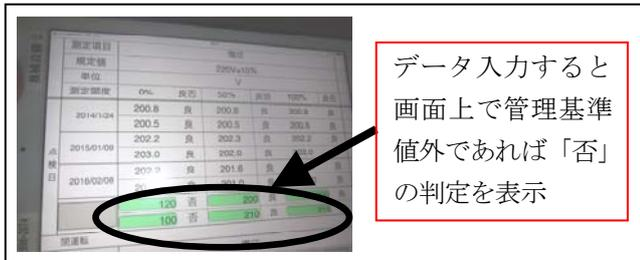
図-4 電流値等の点検計測時管理データ良否判定
