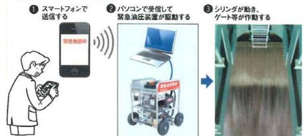
図-8 緊急油圧装置遠隔操作イメージ図
