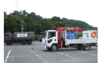
写真－5 市役所に到着した排水ポンプ車
