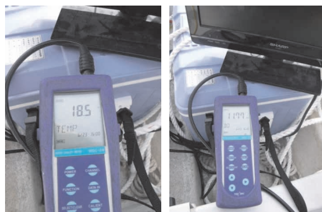
写真-2 試行 2 の稼働状況確認 （左：水温 18.5°C、右：D0 値 11.77）
