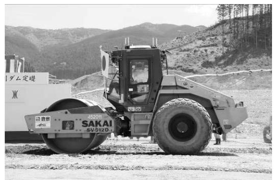
写真-8 自動化重機による締固め
