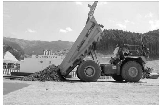
写真-6 自動化重機による運搬
