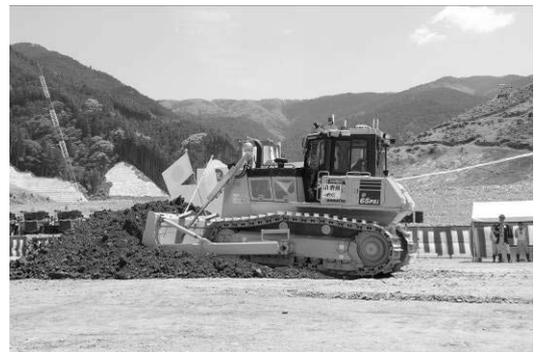
写真-7 自動化重機による敷均し
