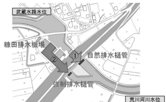
図-2 糠田排水機場の運転条件
