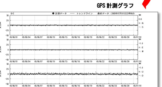
図-5 3次元モデルを起点にした計測監視グラフ及び施工情報へアクセス
