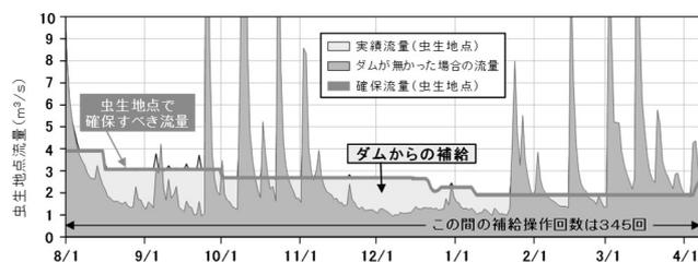
図-6 利水基準点の河川流量とダムからの補給状況
