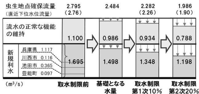
図-5 取水制限時の確保流量
