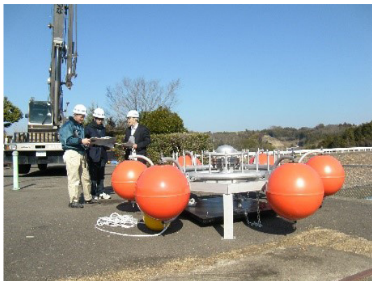
アオコ発生状況・冬期の水位変動操作状況(上)と曝気循環設備(下)(蜂屋調整池)
