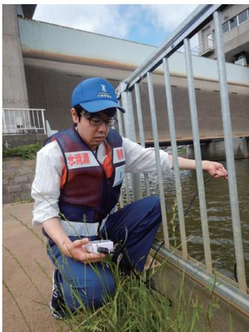
ポータブル水質計による計測
