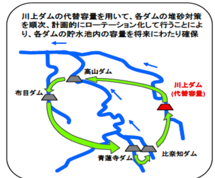
既設ダムの堆砂除去のための代替補給のイメージ
