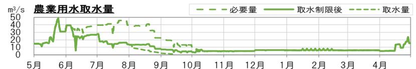
■事象(S1)と同様に、貯水量に応じた取水制限段階(4段階)を設定
