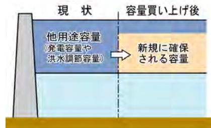
◇他用途ダム容量買い上げによる容量確保のイメージ
