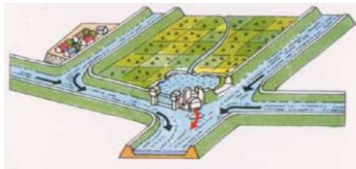
② 中小洪水の時は、遊水地内の水をポンプで吐き出し、浸水させない
