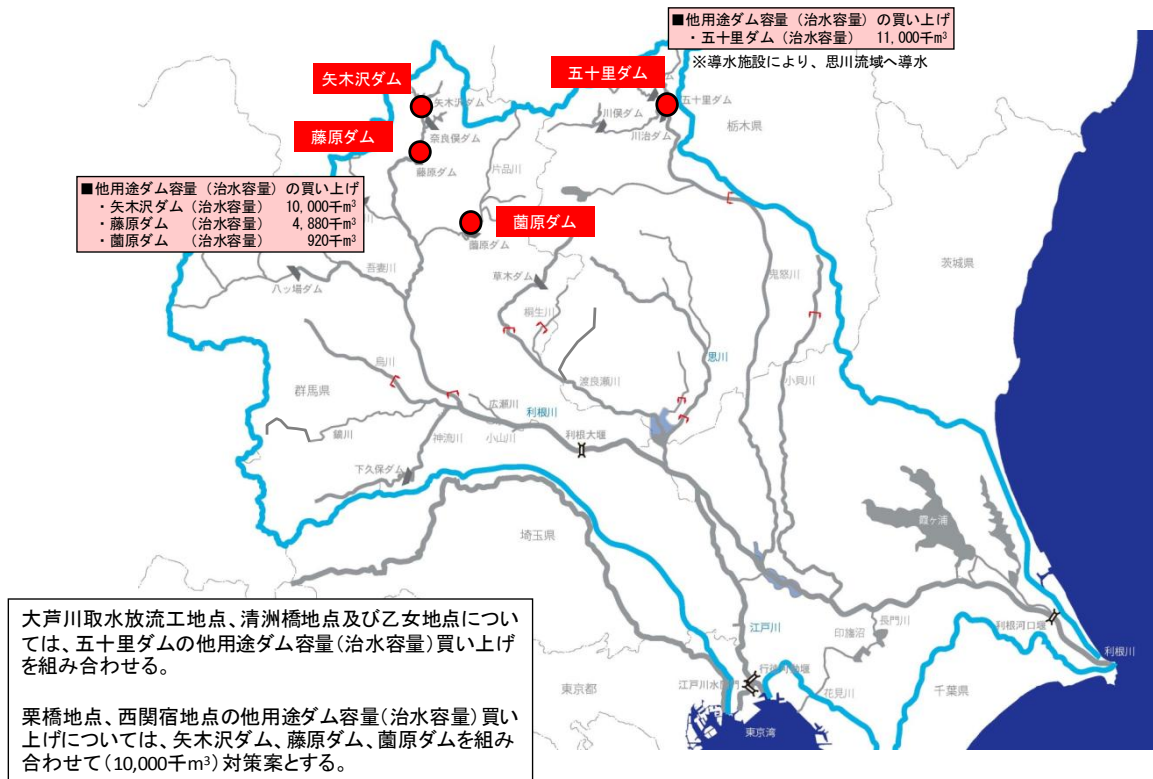
図4.3-39 【ケース2】他用途ダム容量（治水容量）の買い上げによる新規利水対策案
