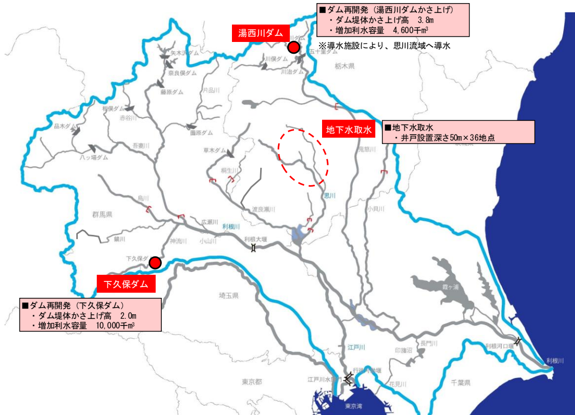
図4.3-38 【ケース1-3】地下水取水による新規利水対策案の概要
