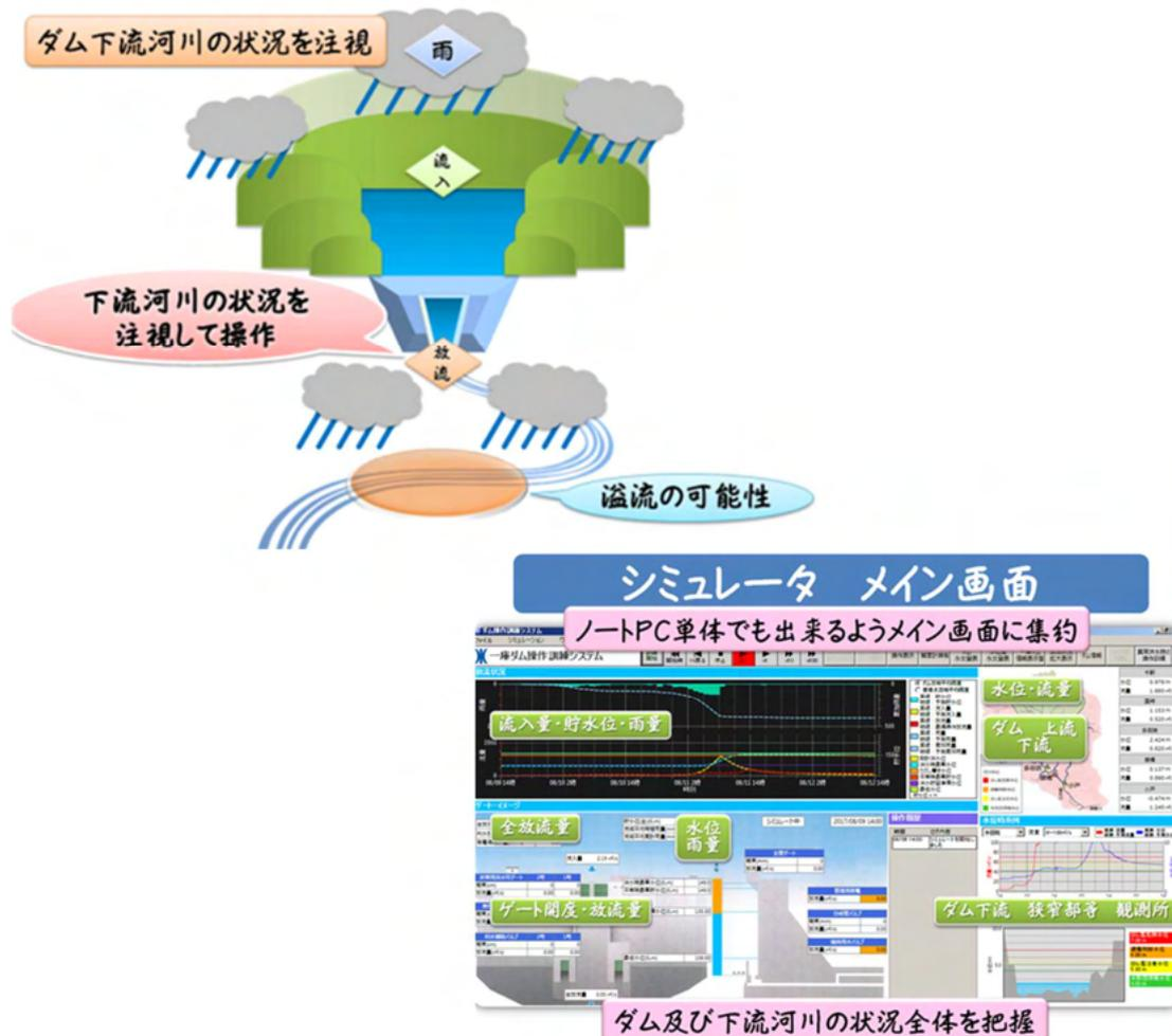
図 ダム操作訓練シミュレータ概念図
