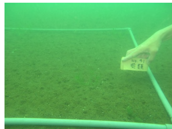
●設置した方形枠(25×25cm:底生動物調査)
