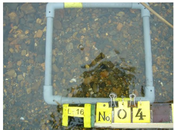
●設置した方形枠(25×25cm:底生動物調査)
